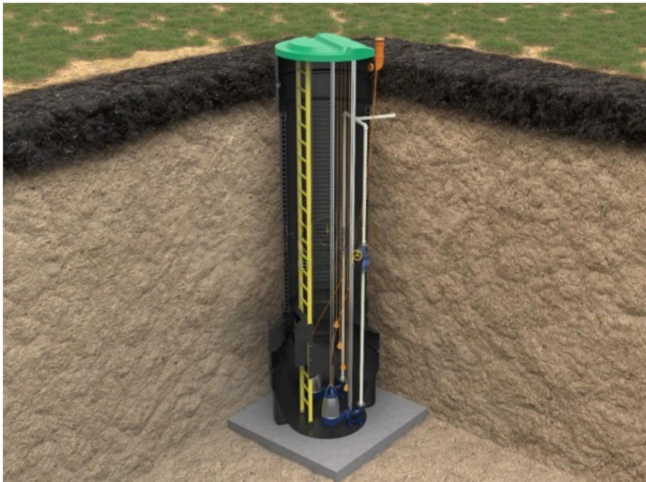
Дренажные и ливневые насосные станции представляют собой подземные и наземные герметичные установки изготовленные на базе прочных полиэтиленовых емкостей и колодцев внутрь которых установлен напорный трубопровод, обратные клапаны, задвижки присоединенные к дренажным, погружным насосам.
