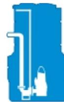
Полностью готовые дренажные насосные станции в прочном бесшовном полиэтиленовом корпусе для перекачивания ливневых, дождевых сточных вод с трубной обвязкой, насосами Grundfos, KSB, Zenit, Pedrollo, DAB, Джилекс высотой от 2 до 8 метров с диаметром корпуса 1000 - 1500 мм.
