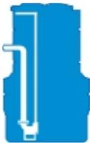
Готовые вертикальные колодцы под КНС с обвязкой для установки 2-х насосов фекального или дренажного типа. Комплект поставки включает в себя бесшовный корпус с крышкой, подводный патрубок, напорный трубопровод, обратные клапана и задвижки.
